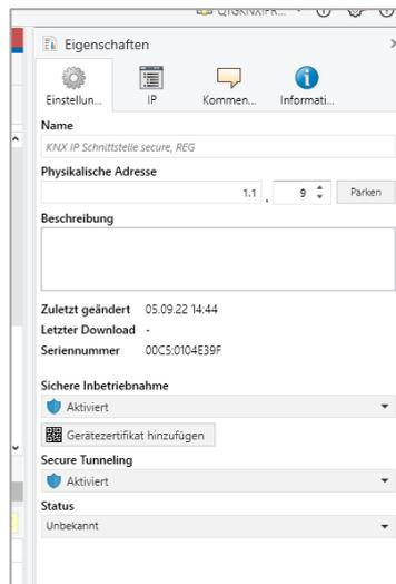
Wenn Secure Tunneling aktiviert ist, wird automatisch ein Passwort für jeden Tunnel vergeben. Dieses Passwort wird unter Menüpunkt „Einstellungen“ angezeigt, wenn ein Tunnel ausgewählt ist.
