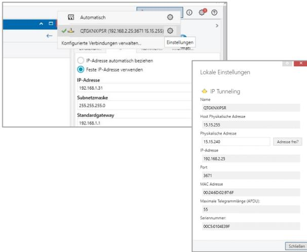
Die physikalische KNX Geräteadresse sowie die physikalischen KNX Adressen für die zusätzlichen Tunneling Verbindungen können innerhalb des ETS Projekts geändert werden, nachdem das Gerät dem Projekt hinzugefügt wurde.
