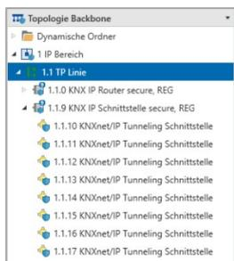
Um die einzelnen Adressen zu ändern, ist der entsprechende Eintrag in der Liste zu markieren und im Textfeld die gewünschte Adresse einzugeben. Sollte der Rahmen des Textfeldes, nach Eingabe, seine Farbe auf Rot wechseln weist dies darauf hin, dass die eingegebene Adresse bereits verwendet wird.
