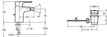
Descriptif CCTP : Mitigeur bidet avec flexibles d'alimentation. E72279. Collection : ALEO. POIDS : 2,1 kg. MATÉRIAU : Métal. TYPE D'INSTALLATION : 1 trou. NORMES ET RÉGLEMENTATIONS : ACS : 10 ACC LY 113. TYPE : Mitigeur. DÉBIT (L/MN SOUS 3 BAR) : 5 l/mn. HAUTEUR TOTALE DU ROBINET (MM) : 143. SAILLIE DU BEC (MM) : 103. RACCORDS : Avec flexibles d'alimentation. MÉCANISME : Cartouche à disques céramique.
