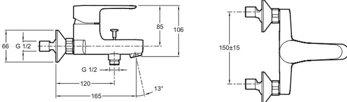
Kurzbeschreibung: Badewannen-Mischer. E16033-4. Kollektion: JULY. GEWICHT: 2,2 kg. MATERIAL: Messing. INSTALLATIONSART: Wandmontage. ART: Einhebelmischer. DURCHFLUSSMENGE: 20 l/min.. BETÄTIGUNGSMECHANISMUS: Keramik-Kartusche. INSTALLATIONSTYP: Wandmontage.
