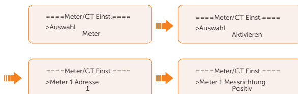
Abbildung 14-21 Meter für den Wechselrichter einstellen
