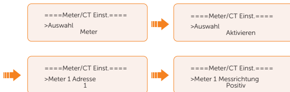
Abbildung 14-16 Meter für den Wechselrichter einstellen
