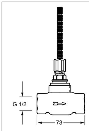
UP-Ventil mit Keramikscheiben und Gewindeanschluss DN 20
