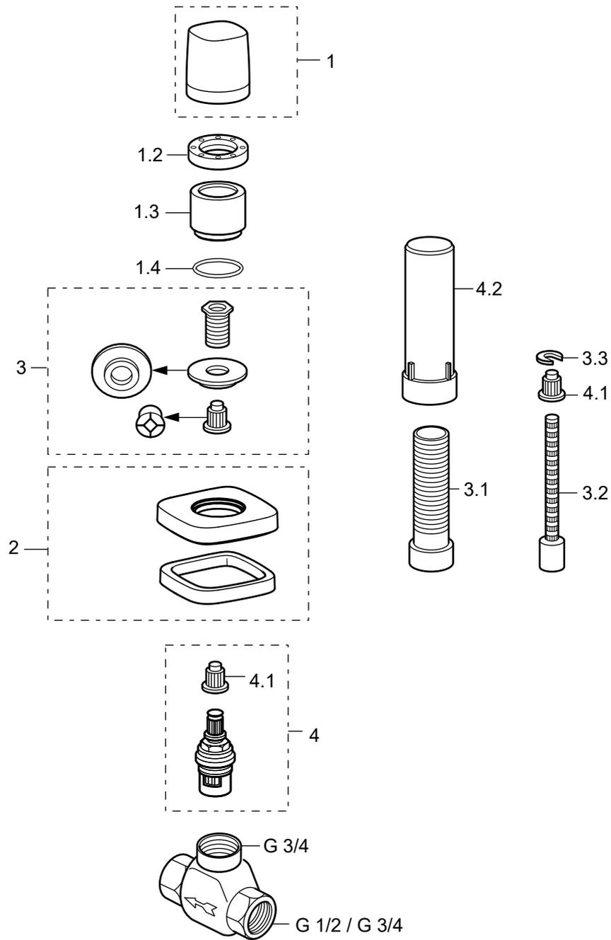
UP-Ventil mit Keramikscheiben und Gewindeanschluss DN 15
