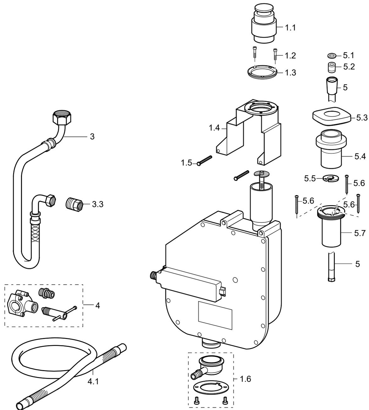
Universaleinbaukörper für Brause mit Aufrollautomatik
