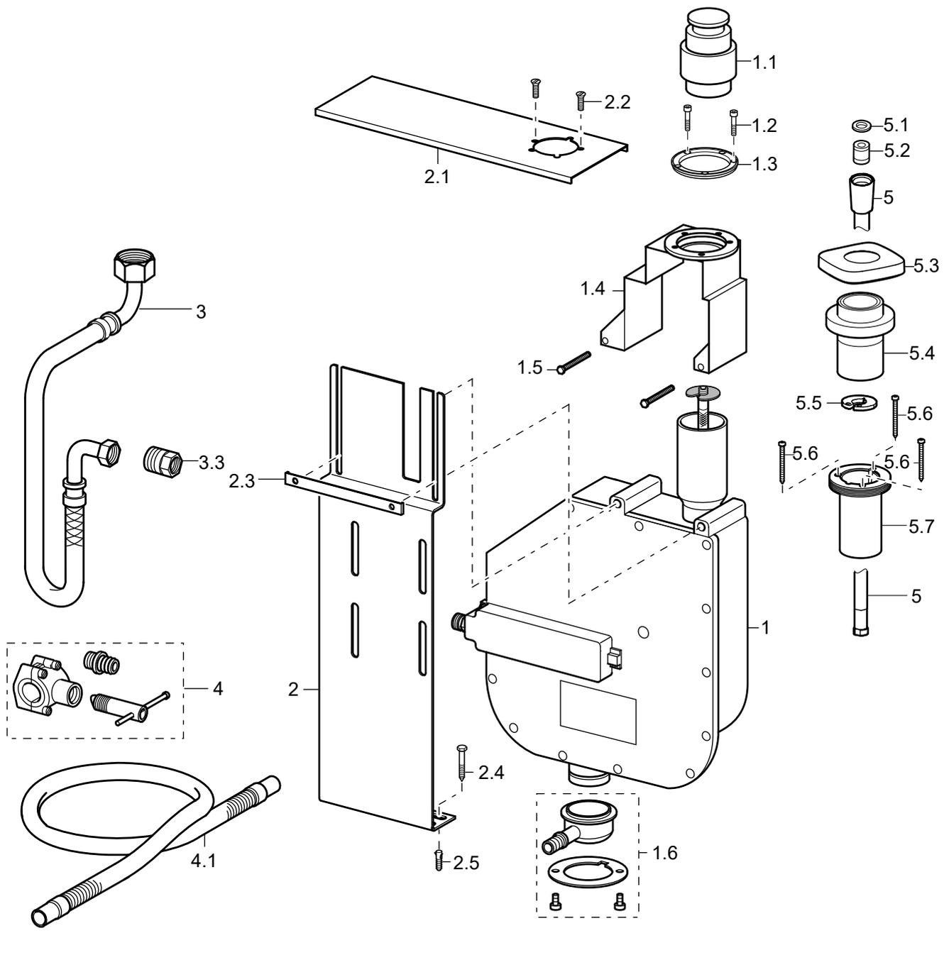
Universaleinbaukörper für Brause mit Aufrollautomatik
