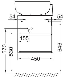
Kurzbeschreibung: UB-Schrank 45 cm, R. EB3045D. Kollektion: NOUVELLE VAGUE. MÄBE: 45,20 x 30 x 46,80 cm. GEWICHT: 9,9 kg. MATERIAL: Lack- und Melaminbeschichtung. INSTALLATIONSART: Wandmontage.
