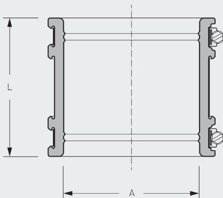
Drain Link Schlauchadapter - für erdverlegte und oberirdische Entwässerungssysteme innerhalb und außerhalb von Gebäuden, zum Verbinden von Spitzenden mit gleichem Außendurchmesser.
