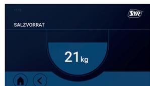
Die Menge des Salzes in kg wird durch einen Ultraschallsensor automatisch berechnet. Sie kann nicht manuell eingestellt werden.
