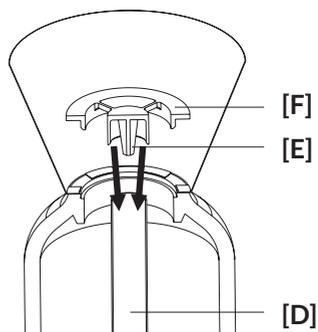
Füllen Sie nun das entsprechende Granulat durch den Trichter in die Kartusche.
