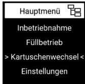
Drücken Sie die  $\checkmark$ -Taste, um den Wechsel der Kartusche zu starten.
