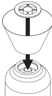
Setzen Sie den Trichter auf die Öffnung der Kartusche und zentrieren Sie die Lanze [D] in der Kartusche mit dem Dorn [E] der Zentrierscheibe [F].
