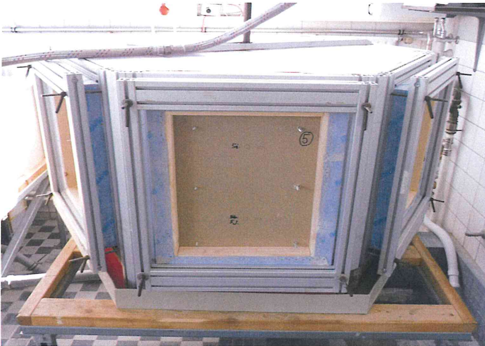
Bild 6: Prüfeinrichtung zur Bebrausung gemäß EAD 030352-00-0503/ EAD 030436-00-0503, Anhang F
