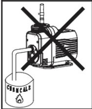
8). Mit der Pumpe dürfen keine brennbaren oder explosiven Flüssigkeiten befördert werden.
