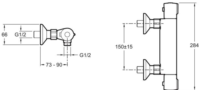
Kurzbeschreibung: Duschthermostat. E8455. Kollektion: JULY. GEWICHT: 2,1 kg. MATERIAL: Messing. INSTALLATIONSART: Wandmontage. ART: Duschthermostat. DURCHFLUSSMENGE: 13 l/min.. BETÄTIGUNGSMECHANISMUS: Thermostatkartusche. INSTALLATIONSTYP: Wandmontage.
