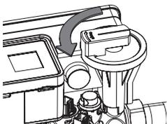
**5.** Öffnen Sie die ausgangsseitige Absperrung.
