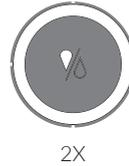
**2.** Drücken Sie 2x die HotKey-Taste, um die Befüllung zu deaktivieren und die eingangsseitige Absperrung zu schließen.
