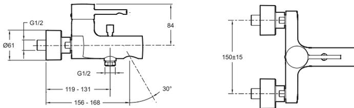
Kurzbeschreibung: Einhebel-Wannenmischer - Aufputzmontage. E45532. Kollektion: CUFF. GEWICHT: 2,6 kg. MATERIAL: Messing. INSTALLATIONSART: Wandmontage. ART: Einhebelmischer. DURCHFLUSSMENGE: 24 l/min.. BETÄTIGUNGSMECHANISMUS: Keramik-Kartusche. INSTALLATIONSTYP: Wandmontage.
