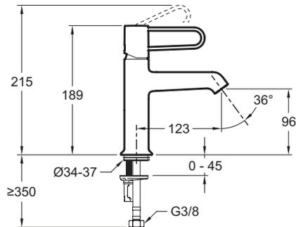
Kurzbeschreibung: 1-Loch Waschtischmischer. E21029-BL. Kollektion: ODÉON RIVE GAUCHE. GEWICHT: 1,3 kg. MATERIAL: Messing. INSTALLATIONSART: 1-Loch. ART: Einhebelmischer. DURCHFLUSSMENGE: 5 l/min.. BETÄTIGUNGSMCHANISMUS: Keramik-Kartusche.
