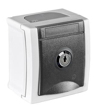
STECKDOSE MIT SICHERHEITSSCHLOSS IM KLAPPDECKEL GRAU NR.1 FR-AP, IP54, SCHLOSS MIT 2 GLEICHEN SCHLÜSSELN, IM VERSCHLOSSENEN ZUSTAND NICHT AUFSCHRAUBBAR ODER DEMONTIERBAR
