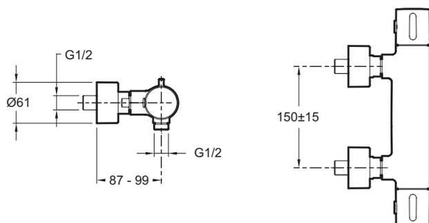
Kurzbeschreibung: Duschthermostat - Aufputzmontage. E37035. Kollektion: CUFF. GEWICHT: 3,1 kg. MATERIAL: Messing. INSTALLATIONSART: Wandmontage. ART: Duschthermostat. DURCHFLUSSMENGE: 13 l/min.. BETÄTIGUNGSMECHANISMUS: Thermostatkartusche. INSTALLATIONSTYP: Wandmontage.
