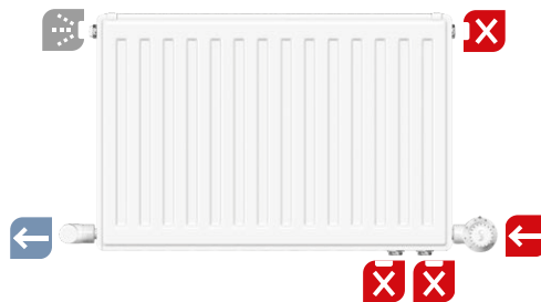
C: Anschluss reitend Achtung: Minderleistung
