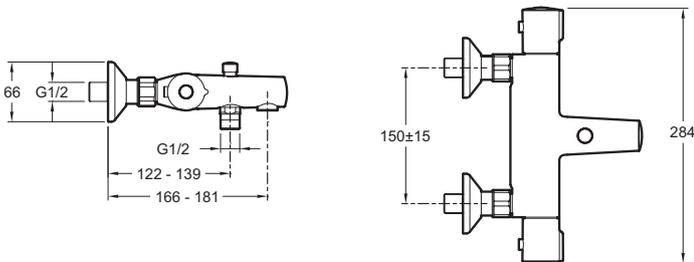
Kurzbeschreibung: Wannenthermostat. E45714. Kollektion: JULY. GEWICHT: 2,1 kg. MATERIAL: Messing. INSTALLATIONSART: Wandmontage. ART: Thermostat. DURCHFLUSSMENGE: 21 l/min.. BETÄTIGUNGSMECHANISMUS: Thermostatkartusche. INSTALLATIONSTYP: Wandmontage.
