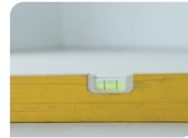
Untergrund muss trocken, tragfähig und eben sein (Toleranz von max. 3 mm pro m). Unebenheiten ggf. vorab ausgleichen.
