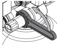
**4.** Drehen Sie den Druckminderer mit Hilfe des Ringschlüssels gegen den Uhrzeigersinn heraus und reinigen Sie ihn mit klarem kaltem Wasser.
