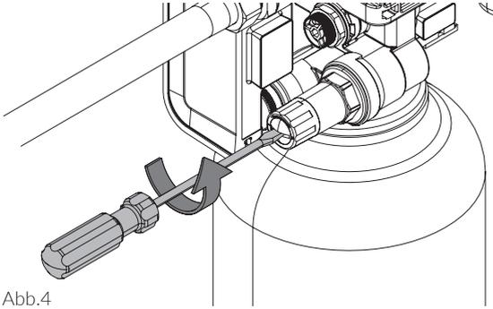
Durch Drehen in Richtung minus verringern Sie den Druck, in Richtung plus wird der Druck erhöht. (Abb.5).
