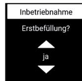
8. Geben Sie mit der  $\blacktriangle$  oder  $\blacktriangledown$ -Taste an, ob es sich um die Erstbefüllung der Heizungsanlage handelt.
