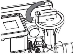
**12.** Öffnen Sie die ausgangsseitige Absperrung.
