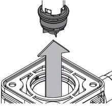
**11.** Entfernen Sie den RV 2, in dem Sie ihn gegen den Uhrzeigersinn herausdrehen.
