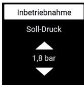
5. Stellen Sie mit der  $\blacktriangle$  oder  $\blacktriangledown$ -Taste den gewünschten Soll-Druck der Heizungsanlage ein.
