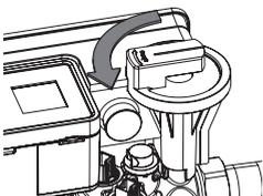
**5.** Öffnen Sie die ausgangsseitige Absperrung.
