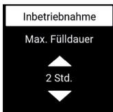
7. Stellen Sie mit der  $\blacktriangle$  oder  $\blacktriangledown$ -Taste die gewünschte maximale Fülldauer ein.
