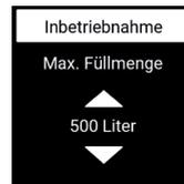
6. Stellen Sie mit der  $\blacktriangle$  oder  $\blacktriangledown$ -Taste die gewünschte maximale Füllmenge ein.
