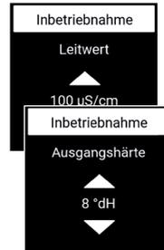
4. Stellen Sie mit der  $\blacktriangle$  oder  $\blacktriangledown$ -Taste den gewünschten Leitwert (nur möglich bei Entsalzung) oder die Ausgangshärte (nur möglich bei Enthärtung) ein.
