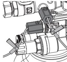
**6.** Montieren Sie die beiden Nadelventile des Messgerätes an die Wartungskugelhähne.
