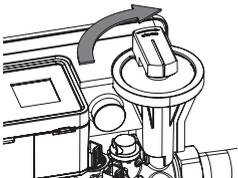
**3.** Schließen Sie die ausgangsseitige Absperrung.
