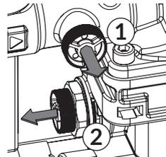
**4.** Entfernen Sie den Manostopfen der Eingangs- (1) und Mitteldruckkammer (2).
