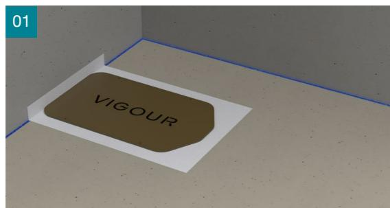
Vor dem Anbringen des Dichtrahmens muss der Untergrund im Bereich der Dichtmanschette grundiert werden. Wir empfehlen den TRINNITY Primer.
