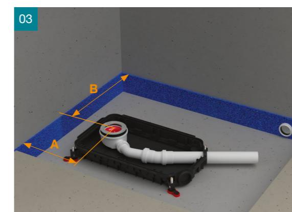
Ablauf in der Box positionieren, Ablaufbox gemäß der Ablaufposition der Duschtasse ausrichten und die Bohrlöcher für die Fußbefestigung anzeichnen.
