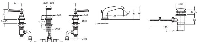
Kurzbeschreibung: 3-Loch Waschtischmischer im Retro Design. E24305. Kollektion: CLÉO 1889. MATERIAL: Messing. INSTALLATIONSART: 3-Loch. ART: Armatur. DURCHFLUSSMENGE: 5 l/min.. HÖHE DES AUSLAUFS: 71 mm. AUSLADUNG DES AUSLAUFS: 123 mm.
