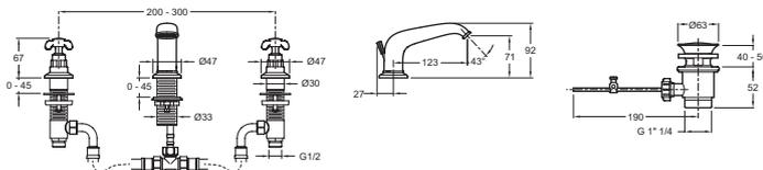
Kurzbeschreibung: 3-Loch Waschtischmischer im Retro Design. E24306. Kollektion: CLÉO 1889. MATERIAL: Messing. INSTALLATIONSART: 3-Loch. ART: Armatur. DURCHFLUSSMENGE: 5 l/min.. HÖHE DES AUSLAUFS: 71 mm. AUSLADUNG DES AUSLAUFS: 123 mm.
