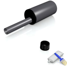
/Reduzierstück in größeres Rohr einsetzen, Gleitmittel auftragen und kleineres Rohr einschieben.
