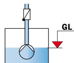
Erreicht der Wasserstand das Niveau „Grundlast AUS“, wird der Wasserstand durch die Nachlaufzeit auf das Niveau „Nachlaufzeit AUS“ (NLZ AUS) abgesenkt. Danach schaltet sich die Pumpe aus.
