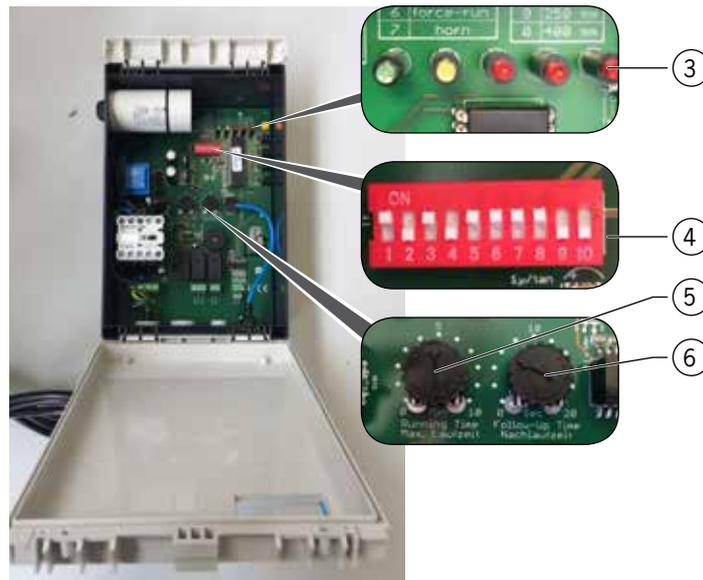
Abbildung: Übersicht der Bedien- und Anzeigeelemente –Innen –
