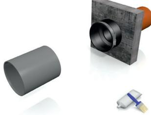
/ Steckadapter bis zum Anschlag in das Rohr drücken.
