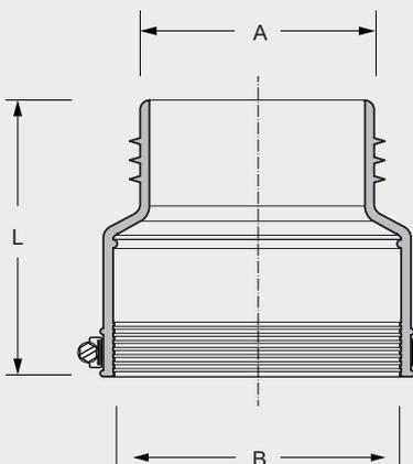
Drain Link Steckadapter – für die Verbindung von Rohren gleicher Nennweiten und unterschiedlichen Werkstoffen.
