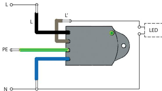
Anschluss mit Isolierung von L' / Isolated connection L'
