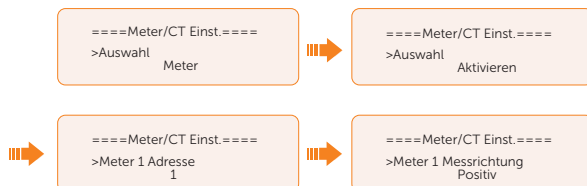
Abbildung 14-19 Meter für den Wechselrichter einstellen
