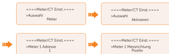
Abbildung 14-24 Meter für den Wechselrichter einstellen
