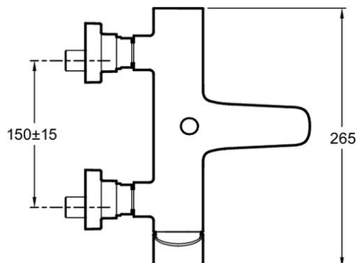
Kurzbeschreibung: Einhebel-Wannenmischer. E72282. Kollektion: ALEO. GEWICHT: 2,9 kg. MATERIAL: Messing. INSTALLATIONSART: 2-Loch. ART: Einhebelmischer. INSTALLATIONSTYP: Wandmontage.
