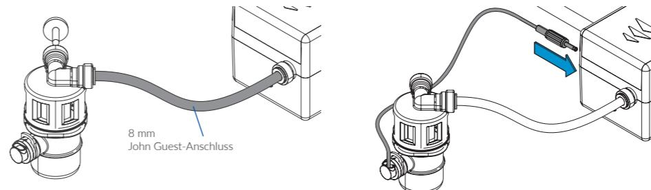
Verlegen Sie den Ablaufschlauch zum Trichter immer mit Gefälle!
