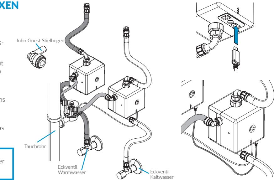
Verlegen Sie den Ablaufschlauch zum Trichter immer mit Gefälle!
