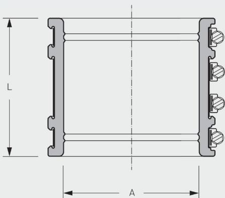
Drain Link Schlauchadapter Typ 2B - für erdverlegte und oberirdische Entwässerungssysteme innerhalb und außerhalb von Gebäuden, zum Verbinden von Spitzenden mit gleichem Außendurchmesser.
