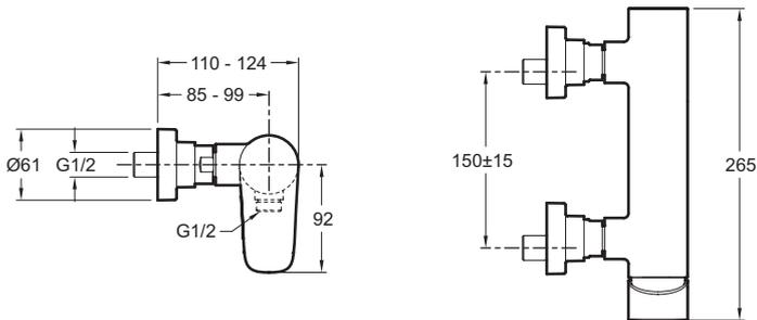
Kurzbeschreibung: Einhebel-Duschmischer . E72351. Kollektion: ALEO. GEWICHT: 2,6 kg. MATERIAL: Messing. INSTALLATIONSART: Wandmontage. ART: Einhebelmischer. DURCHFLUSSMENGE: 13 l/min.. BETÄTIGUNGSMECHANISMUS: Keramik-Kartusche. INSTALLATIONSTYP: Wandmontage.
