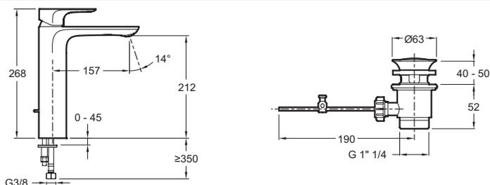
Kurzbeschreibung: 1-Loch Waschschalenmischer, hoch. E72298-4. Kollektion: ALEO. GEWICHT: 2,6 kg. MATERIAL: Messing. INSTALLATIONSART: 1-Loch. ART: Einhebelmischer. DURCHFLUSSMENGE: 5 l/min.. BETÄTIGUNGSMECHANISMUS: Keramik-Kartusche. INSTALLATIONSTYP: 1-Loch.
