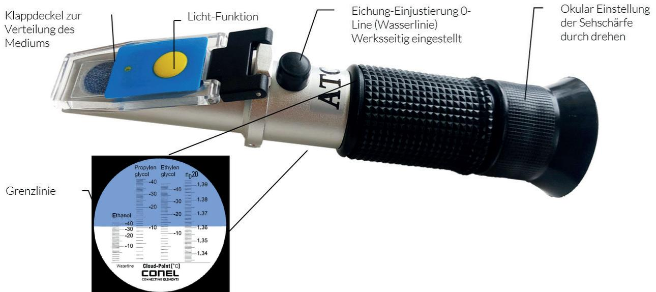
Das Handrefraktometer bestimmt den **Eisflockenpunkt (Cloud-point)** von Wasser-Propylenglykol-, Wasser- Ethylenglykol- und Wasser- Ethanolgemischen und den  $n_D^{20}$  Brechungsindex von beliebigen Flüssigkeiten.
