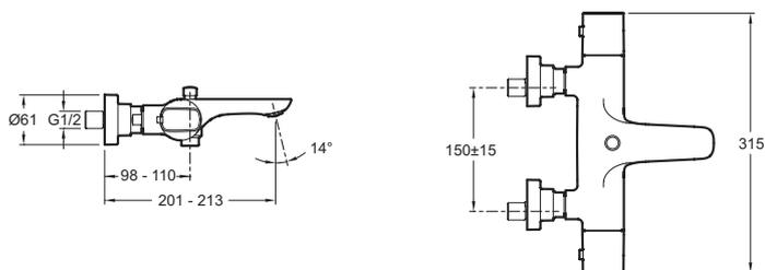
Kurzbeschreibung: Wannenthermostat. E72286. Kollektion: ALEO. GEWICHT: 3,5 kg. MATERIAL: Messing. INSTALLATIONSART: Wandmontage. ART: Thermostat. DURCHFLUSSMENGE: 24 l/min.. BETÄTIGUNGSMECHANISMUS: Thermostatkartusche. INSTALLATIONSTYP: Wandmontage.
