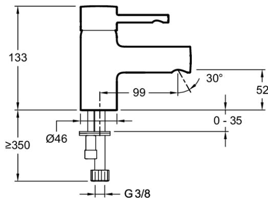
Kurzbeschreibung: Einhebel-Waschtismischer, niedrig, ohne Exzenter-Ablauf. E98297. Kollektion: CUFF. GEWICHT: 1,5 kg. MATERIAL: Messing. INSTALLATIONSART: 1-Loch. ART: Einhebelmischer.
